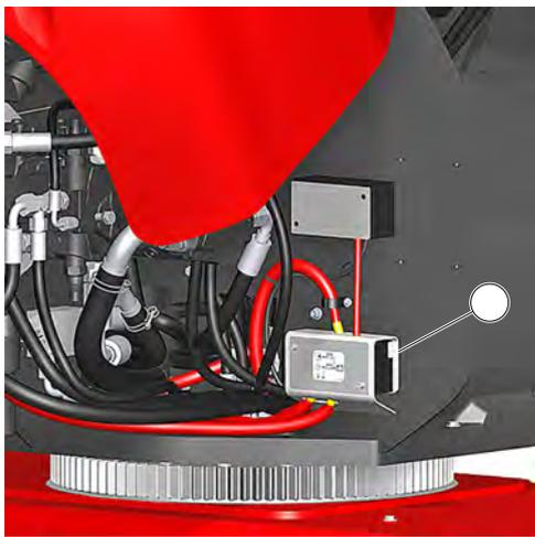
Figure 115: Localisation boîtier fusibles
