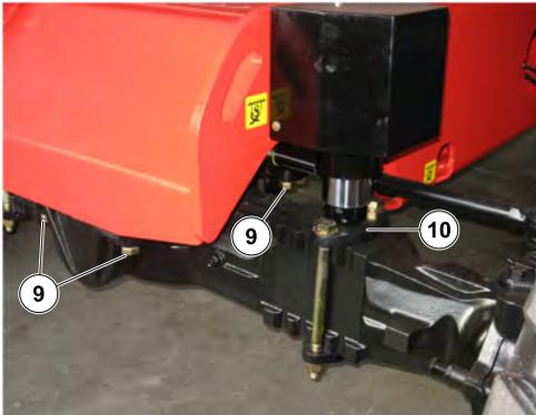
Figure 55: Fixation Pont / Châssis
