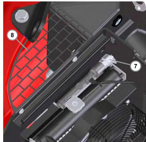
Figure 17: Raccord radiateur huile et grille radiateur
