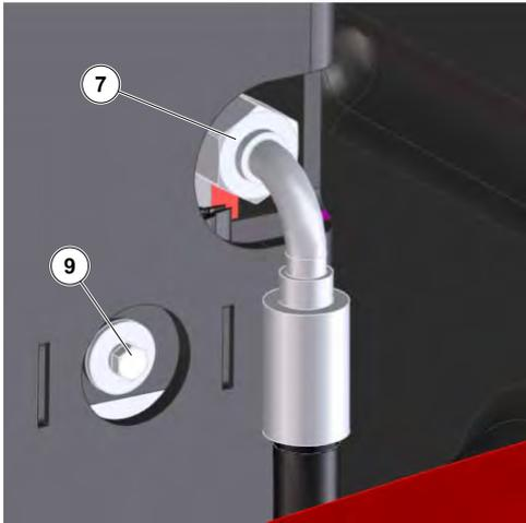
Figure 18: Raccord radiateur huile et vis fixation
