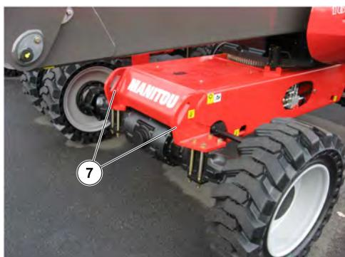
Figure 59: Localisation élingage châssis arrière
