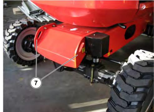
Figure 53: Elingage châssis avant
