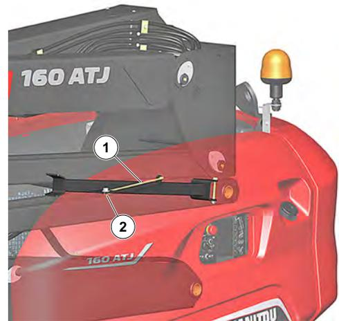
Figure 9: Localisation béquille et rondelle écrou
