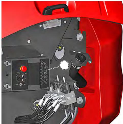
Figure 119: Localisation boîtier Fusibles/Relais Panneau de commande au sol
