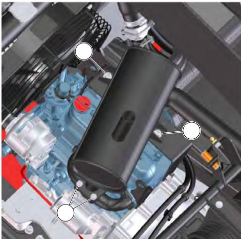
Figure 19: Vis fixation silencieux
